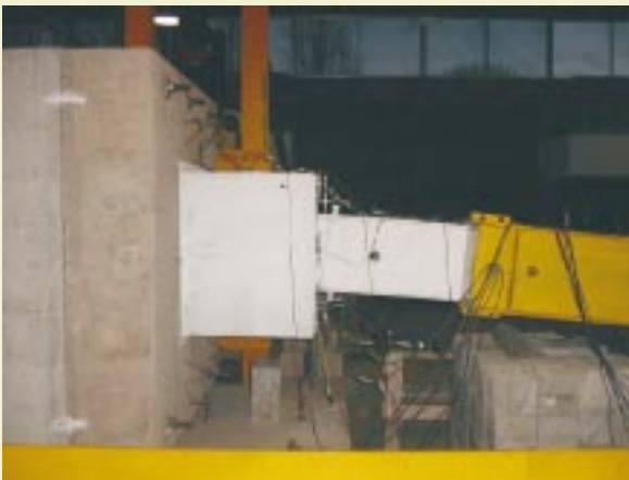
Fotografías tomadas en ensayo de pilar prefabricado empotrado en cáliz, realizado recientemente en Dictuc, por el ICH, Preansa, Pretesa y Tensocret
